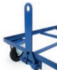
Timon + Attelage, Timon en acier plat d'épaisseur 5 mm, Longueur 280 mm, Attelage soudé sous le cadre, Flèche Ø 15 mm Référence.: 01ZD/583
